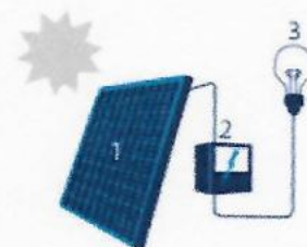
1. Zonnepaneel | 2. Omvormer 3. Elektrische toestellen
